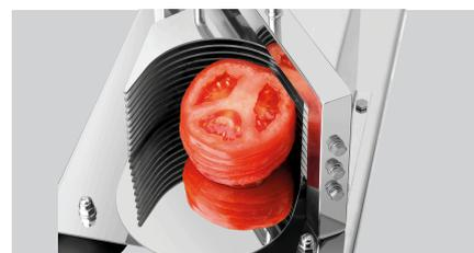
▶ Schneidet Tomaten bis zu einem Durchmesser von 9 cm
