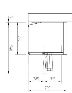
WS.: 300x100 FWw.: DN 20 EZ 400-50-3-N-PE ( Anschluβdose an der Wand, oder 2 Meter freies Kabelende für Direktanschluβ) Potentialausgleich min. 1x6mm2 A.: DN 50 bauseits
