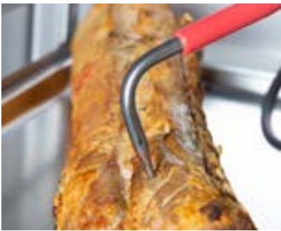
3-Punkt-Temperaturfühler als Standard, 6-Punkt-Temperaturfühler als Sonderzubehör
