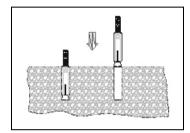
Stecken Sie die Metalldübel mit den Feststellschrauben so wie auf der Abbildung in die gebohrten Löcher im Boden.
