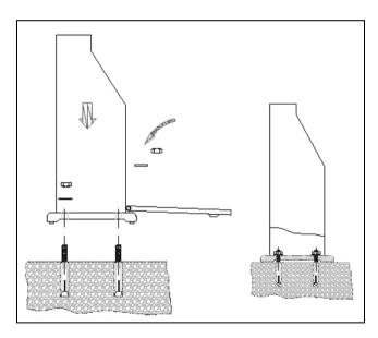
Legen Sie die Unterlegscheiben auf und stellen Sie den Standascher präzise auf die Feststellschrauben der Metalldübel. Befestigen Sie den Standascher dann mit den Muttern und Federringen.
